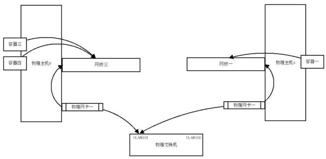
主机 A 和主机 B 的网卡一都连着物理交换机的同一个 vlan 101,这样网桥一和网桥三就相当于在同一 个物理网络中了,而容器一、容器三、容器四也在同一物理网络中了,他们之间可以相互通信,而且可 以跟同一vlan 中的其他物理机器互联。
